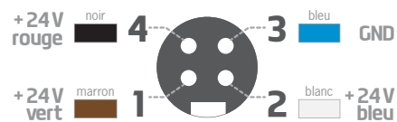
VUE DE FACE DU CONNECTEUR DU PRODUIT
